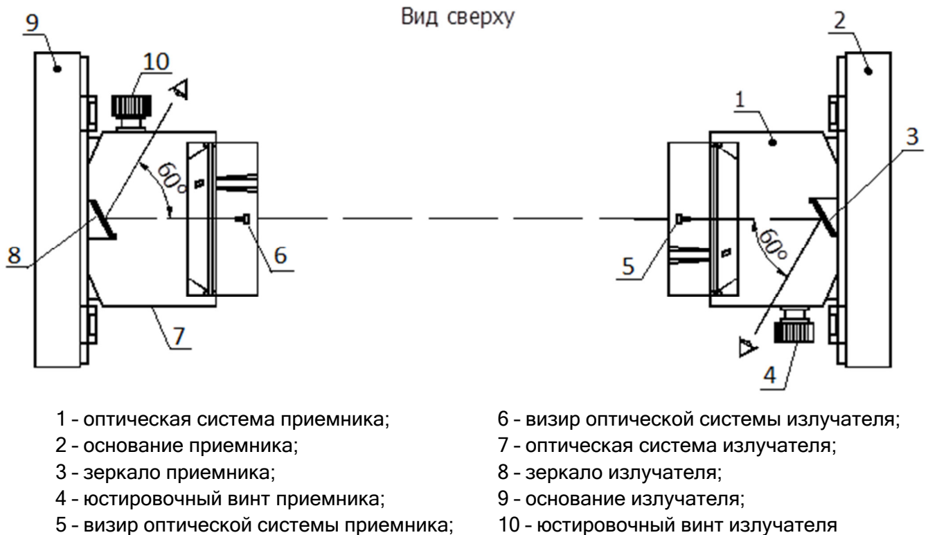
Рисунок 12 - Схема юстировки оптической системы извещателя
